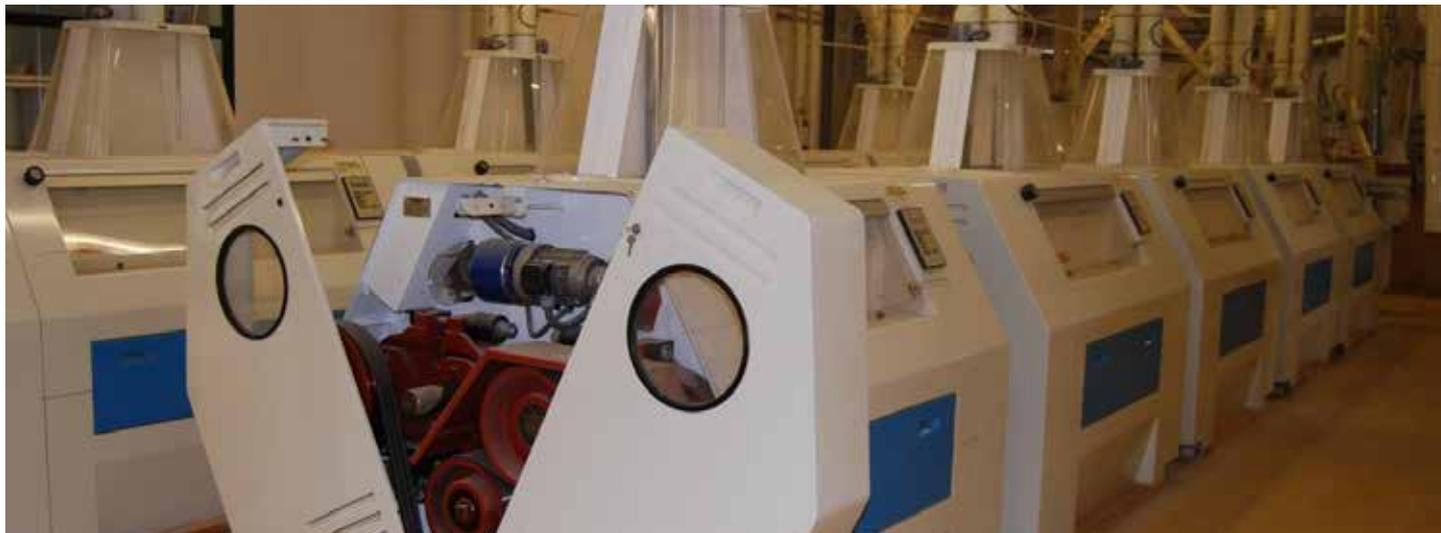
Technalia costruisce impianti per ogni tipo di molitura e quantità di produzione. Il grano prelevato dai silos viene pulito per rimuovere le impurità e viene poi trasferito al **processo di molitura**. La tecnica di molitura più utilizzata è quella a cilindro che utilizza la sequenza della macina.
